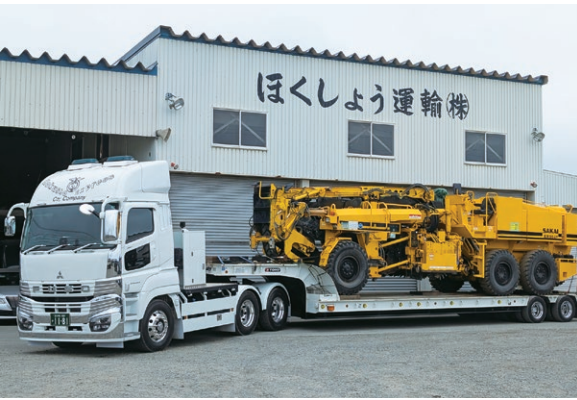
地域第1号となる重トレーラで路面切削機を輸送している様子。
