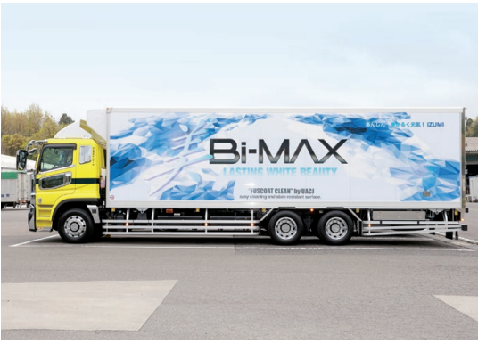
輸送車は「SUPER GREAT」をベースに、前壁・側面・後扉の全面に、(株)矢野特殊自動車製の防汚塗装アルミ板を採用。汚れにくく、かつ汚れを落としやすく、清潔感を維持できる。
