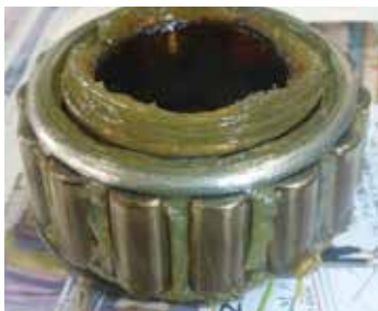
破損していない アウター ベアリング
