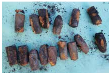
破損した アウター ベアリングの コロ
